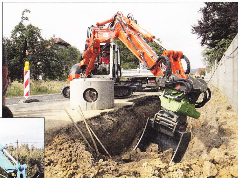
Všestrannost tiltrotátoru německé společnosti HKS při silničních pracích
