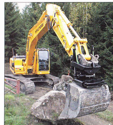
Rýpadlo Hyundai s naklápěcím rotátorem X26 odvaluje balvany
